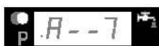
Forzatura calendario (numero massimo dei giorni tra due rigenerazioni) Esempio: una rigenerazione al massimo ogni 7 giorni. Regeneration day override (maximum number of day before a regeneration cycle must occur). For ex.: 7 Days.
